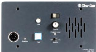
2チャンネルのうち1チャンネルを選択して通話を行うスピーカー付パネル型ステーション。埋込や露出の場合は標準4個口のアウトレットボックスに取り付けて使用。専用のU-BOXにマウントして移動用としても使用可能。コールランプに加えトーンアラートによる呼出機能も有。背面のターミナルブロックでの接続。
