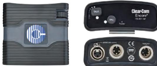
RS-701のIM仕様、基本仕様はRS-701と同等であるが、港湾・船舶での使用により 特化した仕様。IP-53レイティング、塩分及び湿度に対するシーリング対応、アスベストフリー (SOLAS Regulation II-I/3-5.2)、Marine Certification Compliant (DNVGL-CG-0339)、シーリング強化のためRS-701より若干高さが増えています。
