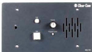
ヘッドセットを使用せず、内蔵のスピーカーとマイクロフォンによって通話を行うパネル型ステーション。主に楽屋やロビー、事務所などで使用。通常はスピーカーがオンとなっており、トークボタンを押すことによってスピーカーが切れ、マイクがオンになる。コールランプとトーンアラートによる呼出機能有。なお、別売の基板によって4Wオプション設定も可能。
