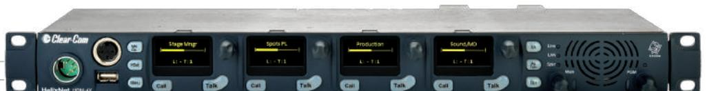
HRM-4X は 1U サイズの 4 コントロールウィンドウ・ラックマウントリモートステーションです。12 または 24 インターカムチャンネルのうち 4ch をアサインしてコミュニケーションできます。メインステーションとの接続は 2 芯シールドケーブルまたは STP CAT5/6+XLR3 (パワーライン) もしくは STP CAT5/6 LAN ケーブル (Ethernet モジュール) によって行います。電源は付属 AC/DC アダプターによるローカル供給が基本となりますが、システムによってパワーラインや PoE での供給も可能です。なお、パワーラインでの HRM-4X への電源供給は各ポート 3 台までとなり、それより多くなる場合はローカル電源や PoE とすることが必要です。
