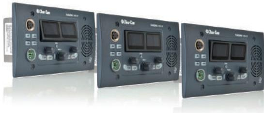
HKB-2X は 4 個口の電工ボックスに実装可能サイズな 2 コントロールウィンドウ、4ch パネルマウントリモートステーションです。接続は 2 芯シールドまたは STP CAT5/6 ケーブルによるパワーライン、もしくは STP CAT5/6 ケーブルによる LAN / PoE 接続が可能。HKB-2X のパワーライン接続用コネクタはスクリューターミナル仕様。12 または 24 インターカムチャンネルのうち 4ch をアサインして使用します。なお表示及び操作部は 2ch 仕様のためシフトスイッチによるワンタッチ切替です。ディスプレイはチルト可能で見やすいポジションに調整できます。
